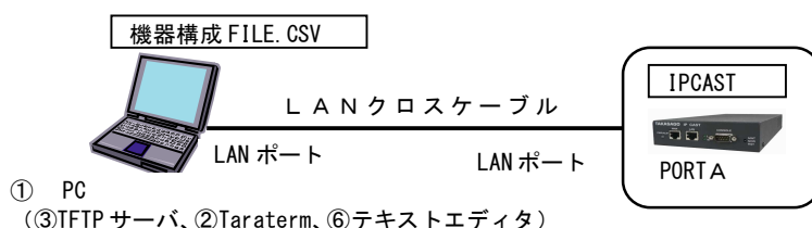
c. 機器構成の登録 (ダウンロード) のための構成イメージ
