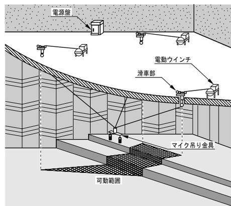
この吊りマイクロホン装置はホール内でのオーケストラ、コーラスなど、ステージ上の演奏の收音や、オーケストラピット又は客席上での各種收音用として使用されるもので、マイクロホンの高さ及び位置を、最大10個までのプリセットメモリに記憶させおき、それを簡単な操作で、呼び出し自動でそのマイクロホンの高さや位置に移動させるデジタル式制御方式により、従来方式に比べ大幅に操作性が向上しました。マイクロホン及びケーブル以外の装置は、全て、天井裏面又は調整室等に格納設置されますので、美観上も申し分ありません。
